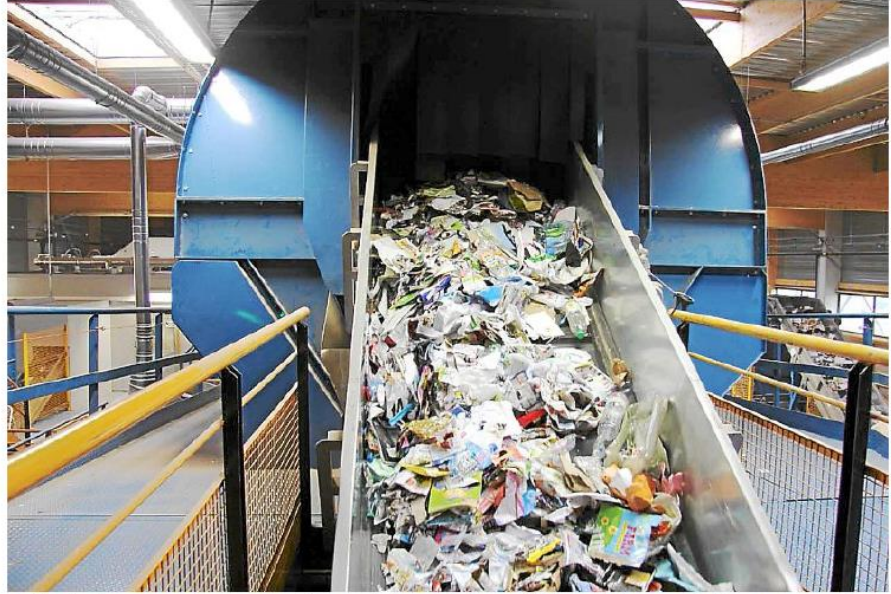
Le tri mécanique sépare les corps creux (flacons plastiques, emballages métalliques...) des corps plats (journaux, magazines, cartons...)
